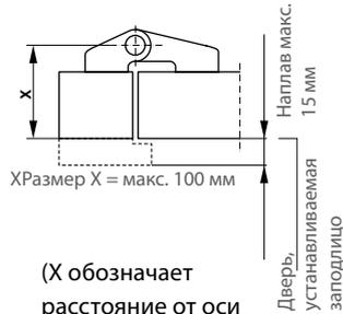
Ограничьте максимальный угол открывания двери стопором или с использованием скользящей шины GEZE T-Stop.
